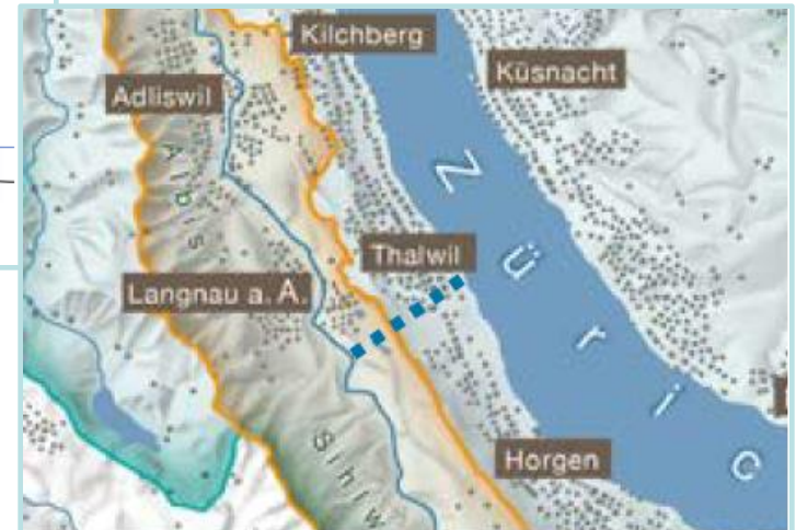
Hochwasserspitzen der Sihl werden oberhalb von Langnau am Albis durch den Entlastungsstollen in den unteren Zürichsee bei Thalwil umgeleitet.
