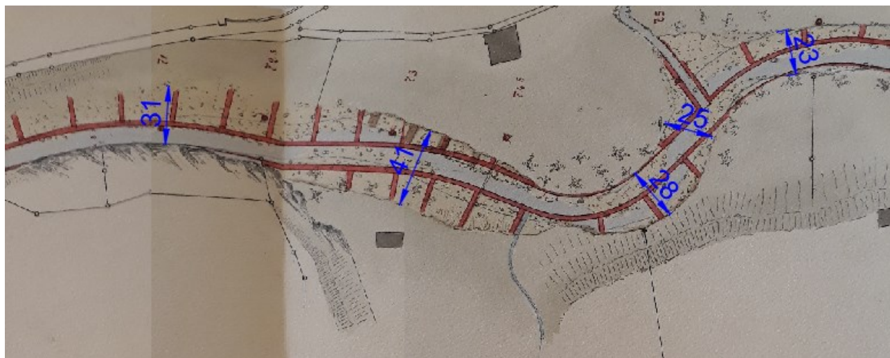
Fig. 25 Extrait du plan d'endiguement de 1893 à la hauteur de Kappelboden jusqu'à la confluence de l'Oberbach et de la Jogne, avec des largeurs pleins bords ( L_{pb} ) mesurées jusqu'à environ 40 m.
