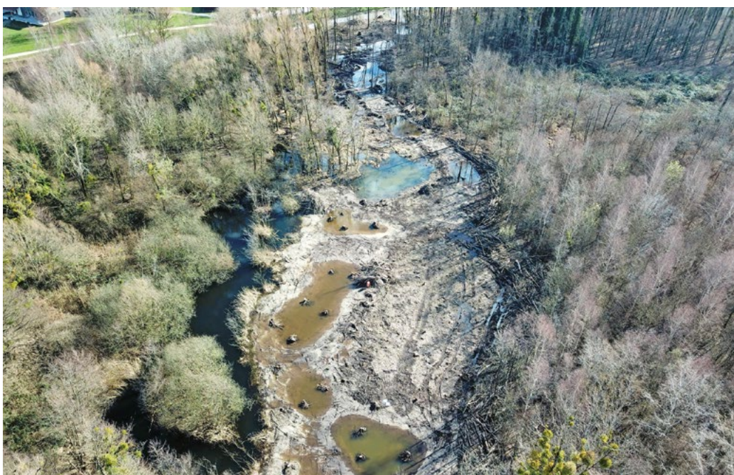
Les dépôts de matériaux existants en rive gauche de l'embouchure, au sein du Bois des Vernes, ont été évacués et des plans d'eau creusés de manière à rétablir un régime hydrique du sol favorable au développement de successions végétales alluviales en station. (© biol conseils)
