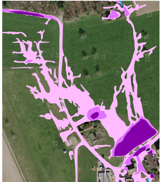
Fig. 25 : En bleu, les tronçons du Buechbach s'écoulant à ciel ouvert ; en violet foncé, le bassin de rétention
