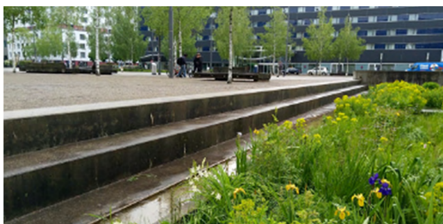
Fig. 53 : Sur la Turbinenplatz, des noues plantées de fleurs absorbent l'eau en cas de fortes précipitations
