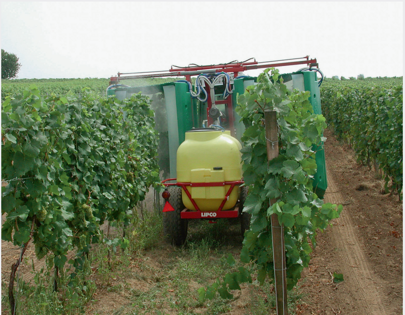
Sprühverluste beim Ausbringen von Pestiziden lassen sich reduzieren, hier mit einem Tunnelspritzgerät im Rebbau. (Foto: K. Bauer, CC-BY 3.0) Les pertes par dispersion, lors de l'épandage de pesticides, peuvent être réduites comme ici en viticulture avec un pulvérisateur en tunnel.
