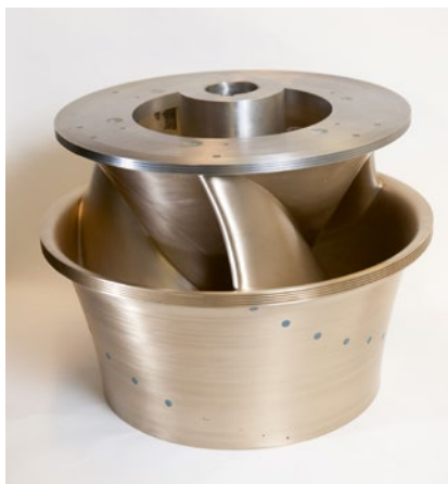
Bild 4: Modell der fischfreundlichen Alden-Turbine, das Modell wird von Voith Hydro für hydraulische und betriebliche Tests verwendet (Quelle: Alden Research Lab)
