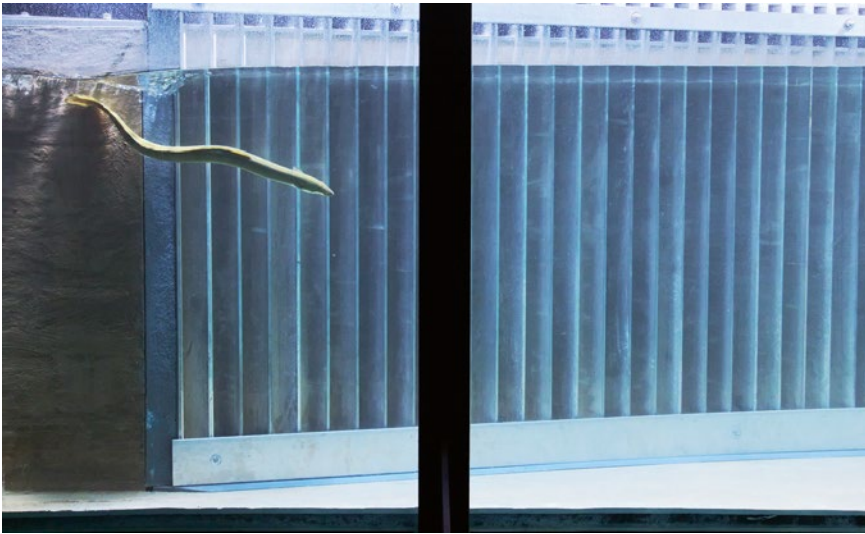
Bild 5: Aal vor der Leiteinrichtung im Modell an der VAW-ETHZ (Quelle: D. Flügel)
